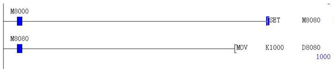
置位 M8080 后直接赋值 1000 给 D8080，把万用表的红表笔接在 DA0 端，黑表笔接在 GND，此时就会有 10V 的电压输出。
